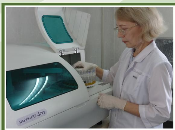
**Универсальный автоматический биохимический анализатор обладает производительностью до 240 анализов в час**
